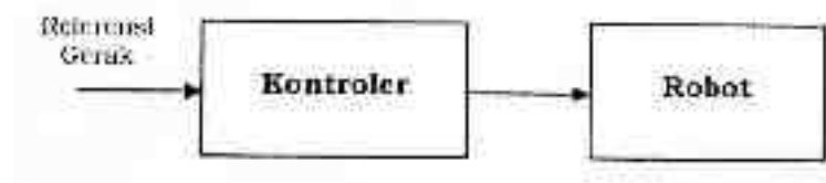
Gambar 1.13 Kontrol robot loop terbuka
