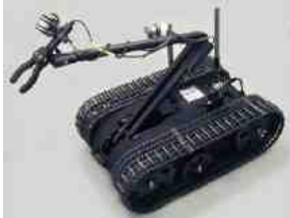
Gambar 1.11 Contoh robot kombinasi Mobile dan Non-mobile
